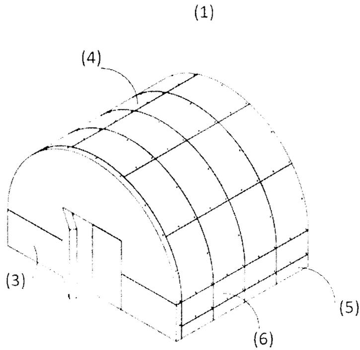
Fig. 1 : Vue isométrique 3D d'assemblage du système de chambre froide isothermique, modulable, autoportante et durable
